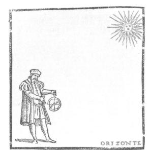
fig. 2. Mariner's Astrolabe. Shown being used to determine the meridian altitude of the sun. From Pedro de Medina, Regimiento de navegación (Seville, 1563), fol. 16
